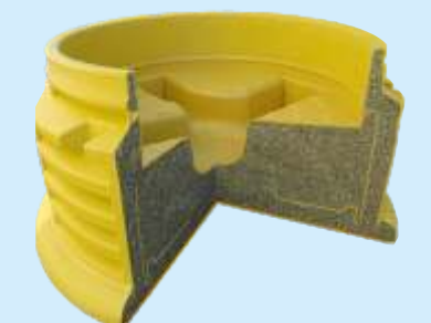
Nadzwyczaj wysoka sztywność dzięki zastosowaniu konstrukcji dwuściennej, możliwość wypełnienia w razie potrzeby wszystkich elementów konstrukcyjnych (np. za pomocą betonu)
