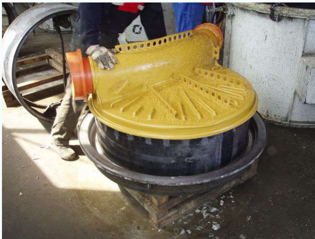
Vorbereitung der Gießformen und Einlegen der Schachtböden.
