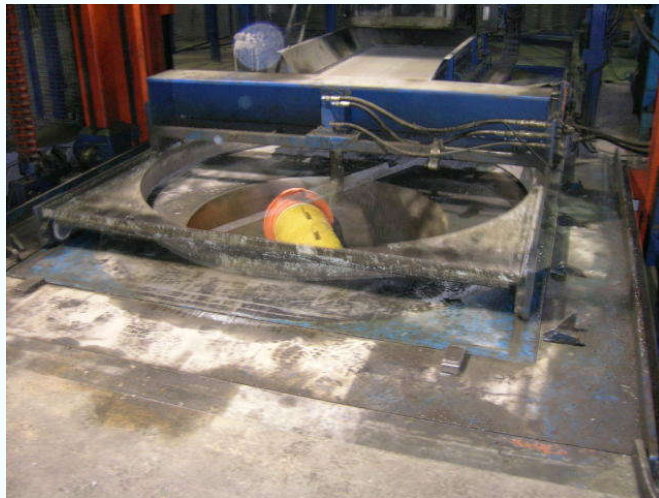
Schachtbodenproduktion bei einem PREDL®-Franchise-Partner in Frankreich.
