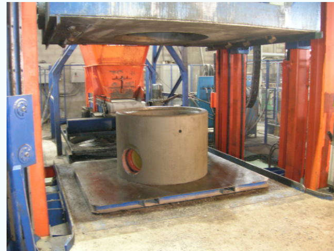
Schachtbodenproduktion bei einem PREDL®-Franchise-Partner in Frankreich.
