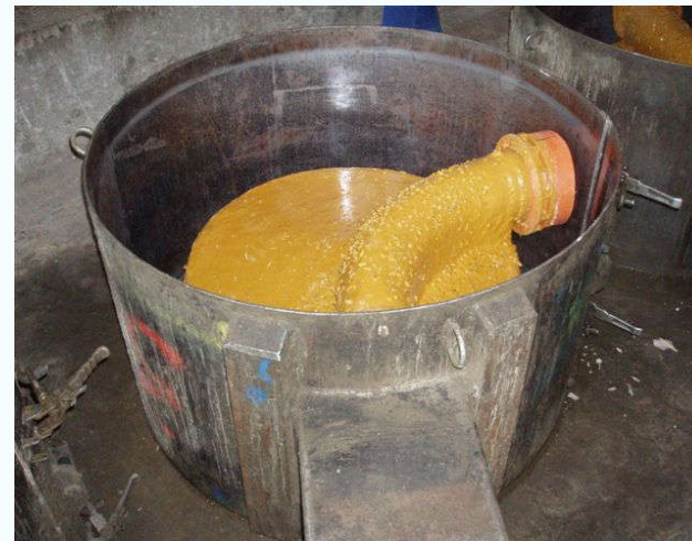
Vorbereitung der Gießformen und Einlegen der Schachtböden.
