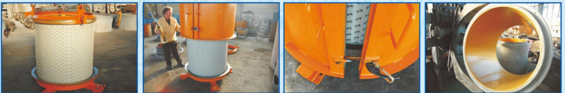
Um die erforderliche Maßhaltigkeit der Ringteile zu gewährleisten, wird empfohlen, die Herstellung im Gießverfahren mit Festentschalung zu bevorzugen oder bei Frischentschalung die Aushärtung der Schachtringe auf der Unter- und Obermuffe zu ermöglichen.
