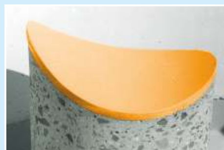
beton klasy co najmniej C40/50 dzięki wykonywaniu metodą na mokro
