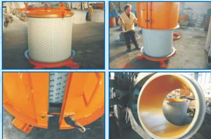
Pro dosažení rozměrové stálosti betonových skruží se doporučuje upřednostnit výrobu zalívací metodou s odformováním až po dostatečném vytvrzení nebo při odformování za čerstva umožnit tvrdnutí skruží na spodním vyvážecím a horním dolisovacím kruhu. Standardní výrobní program PREDL-CORPROTECT® vnitřních vystělek šachtových skruží zahrnuje dle ČSN EN 1917 skruže o výšce 500, 750 a 1000. Atypické rozměry možno vyrobít na zakázku.
