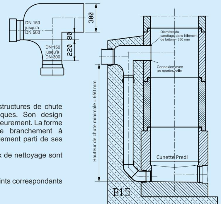
La tête de chute se distingue des autres structures de chute traditionnelles par des avantages spécifiques. Son design unique permet de raccorder des tuyaux ultérieurement. La forme favorable du flux et les possibilités de branchement à contrecourant du réseau principal font également parti de ses avantages.
