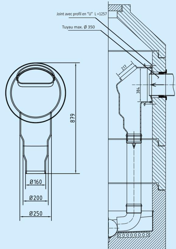
L'Inside Drop Type 2 permet de réaliser des branchements jusqu'à un diamètre extérieur de tuyau de 375 mm. L'accès de maintenance (environ 288 x 221 mm) n'est pas fermé. La sortie offre trois possibilités de diamètres, soit 160 mm, soit 200 mm ou 250 mm de diamètre extérieur. Le rayon est coupé en usine pour correspondre à la paroi du regard.
