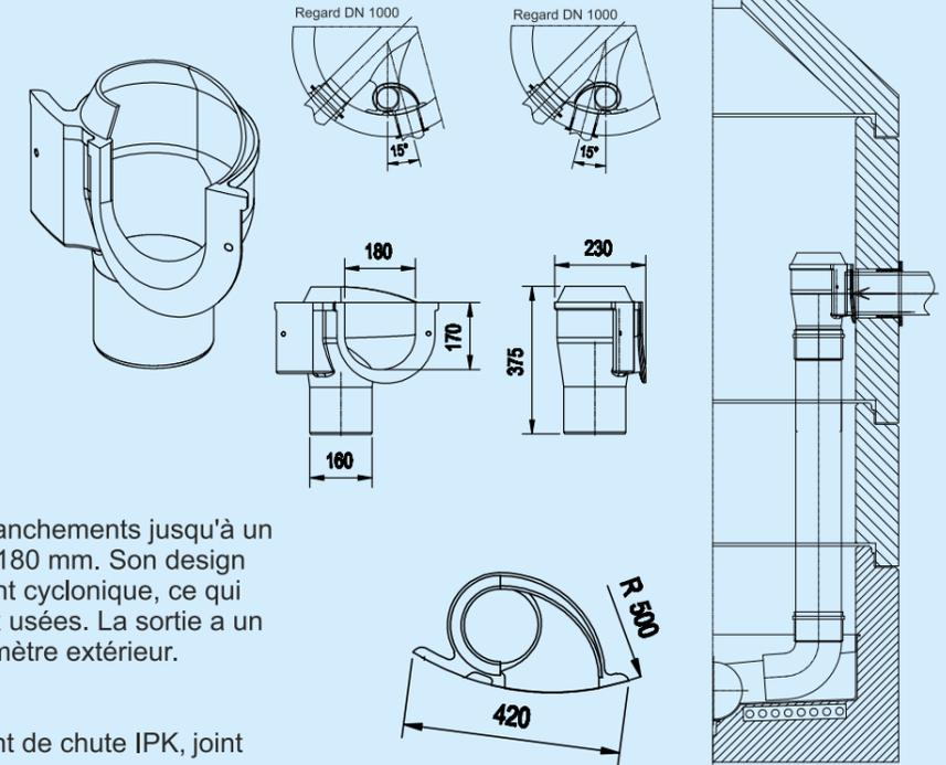
L'IPK permet de réaliser des branchements jusqu'à un diamètre extérieur de tuyau de 180 mm. Son design spécifique assure un écoulement cyclonique, ce qui réduit le flux d'énergie des eaux usées. La sortie a un diamètre de DN160 mm de diamètre extérieur.
