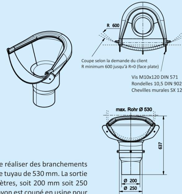
L'INSIDE FUNNEL 500 permet de réaliser des branchements jusqu'à un diamètre extérieur de tuyau de 530 mm. La sortie offre deux possibilités de diamètres, soit 200 mm soit 250 mm de diamètre extérieur. Le rayon est coupé en usine pour correspondre à la paroi du regard.
