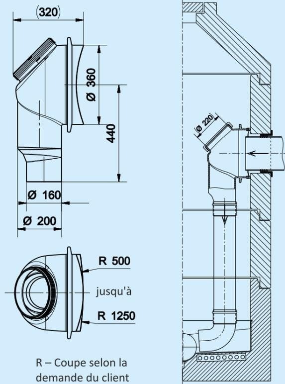
L'Inside Drop Type 1 permet de réaliser des branchements jusqu'à un diamètre extérieur de tuyau de 330 mm. L'accès de maintenance (220 mm) est fermé par un couvercle à visser. La sortie offre deux possibilités de diamètres, soit 160 mm soit 200 mm de diamètre extérieur. Le rayon est coupé en usine pour correspondre à la paroi du regard.
