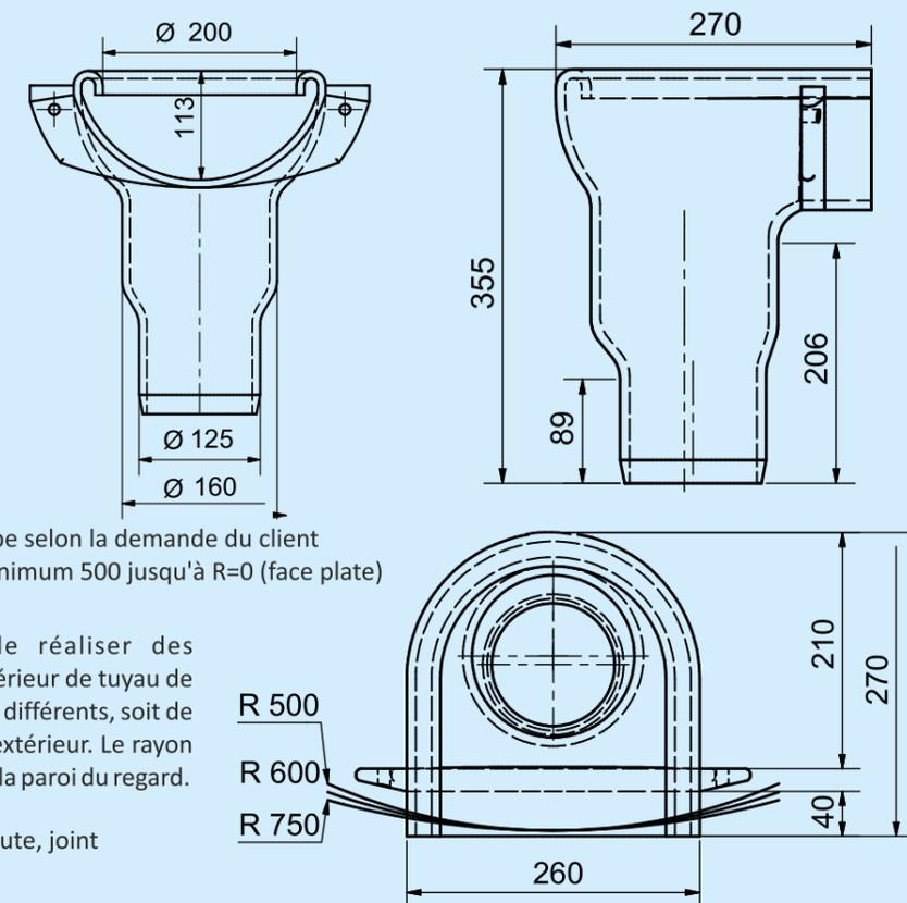
L'INSIDE FUNNEL 200 permet de réaliser des branchements jusqu'à un diamètre extérieur de tuyau de 220 mm. La sortie offre deux diamètres différents, soit de 125 mm soit de 160 mm de diamètre extérieur. Le rayon est coupé en usine pour correspondre à la paroi du regard.
