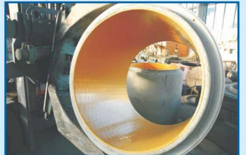
Per garantire il mantenimento delle misure necessarie degli anelli, viene consigliata, la produzione a colata con casseri fissi o, in caso di scasseramento immediato permettendo la maturazione degli anelli del pozzetto su fondelli (reggimisure) superiori e inferiori.
