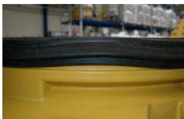
Posizione della guarnizione errata
